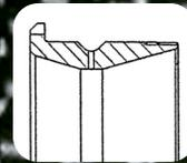
Doppia coppa flangiata per inserimento di due coni per rulli conici, con canalino olio e fori dell'olio.
